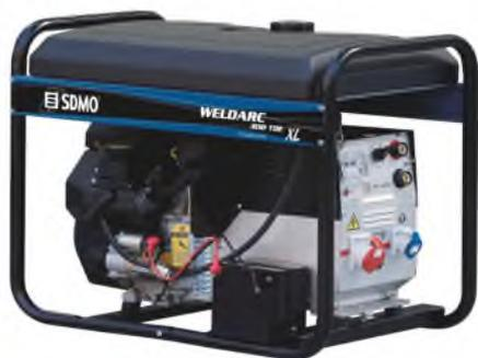
Дизельная электростанция для сварки постоянным током до 300 А. Генератор класса Weldarc предназначен для интенсивных сварочных работ на строительных площадках при отсутствии электричества. Имеет топливный бак большой емкости. Также может использоваться для бытовых целей в качестве источника электроэнергии мощностью до 8 кВт. Установка оснащена дизельным двигателем Kohler Diesel-Fuel OHV.
